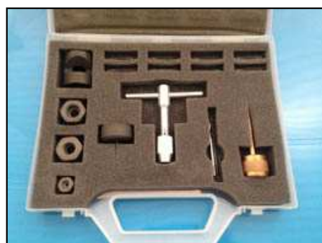
AZ0073-C.R – CASSETTA PER FILTRO A BARRA INIETTORI DENSO
