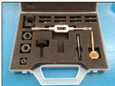
AZ0071-C.R – CASSETTA PER FILTRI ANTI-POLVERE INIETTORI DENSO
