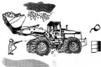
Рис. 10-77: Вода может попасть в гидросистему мобильного оборудования различными способами. Иллюстрация перепечатана с разрешения Общества автомобильных инженеров (SAE), Технический документ 981497 © 1998, Society of Automotive Engineers, Inc.
