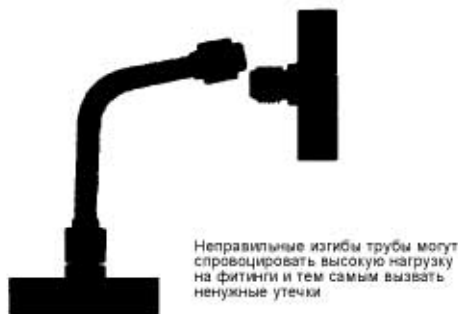
Рис. 12-15 При монтаже важны правильные изгибы трубы
