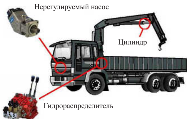
Рис. Кран-1 Грузовик с грузовым краном и основные гидравлические компоненты
