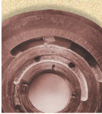
Рис. 11-7 Обычный износ насоса из-за наличия твёрдых примесей и воды в рабочей жидкости
