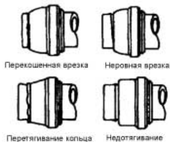
Рис. 12-20 Неправильная предварительная пригонка
