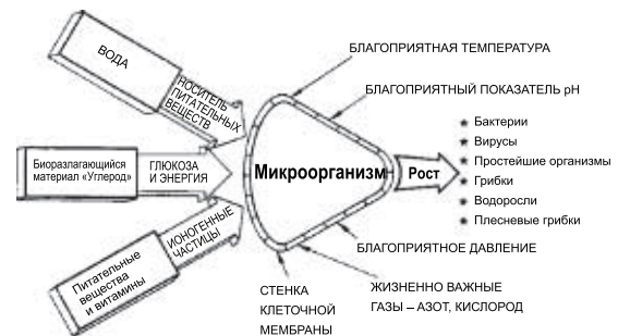
Рис. 10-88: Вода и воздух способствуют развитию микробов в жидкости. (Иллюстрация предоставлена E. C. Fitch, Fluid Contamination Control, FES, Inc.).
