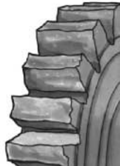
Рис 15-38 Износ зубьев из-за неправильной регулировки бокового зазора.
