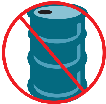
Рис. 10-40: Не допускается хранение бочек с гидравлической жидкостью в вертикальном положении.
