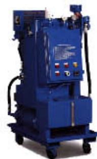
Рис. 10-79: Коалесцирующее устройство – один из способов быстрой обработки рабочей жидкости с излишним содержанием воды.
