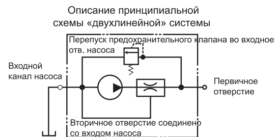
Рис. 13-10 Схематический чертёж «Двухлинейной» энергетической цепи рулевого управления с усилителем
