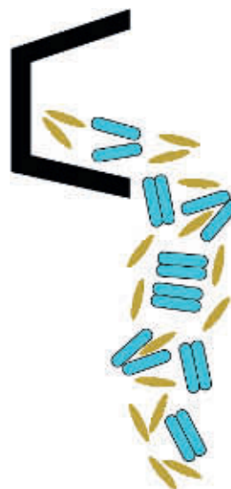
Рис. 10-53: Вязкость инвертной эмульсии выше, чем обычной гидравлической жидкости.
