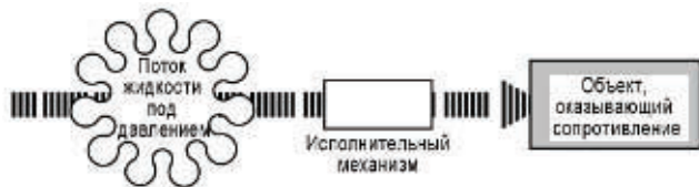
Рис. 2-20 Преобразование энергии из гидравлической формы в механическую
