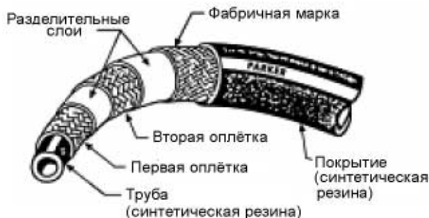
Рис. 12-42 Общая конструкция шланга
