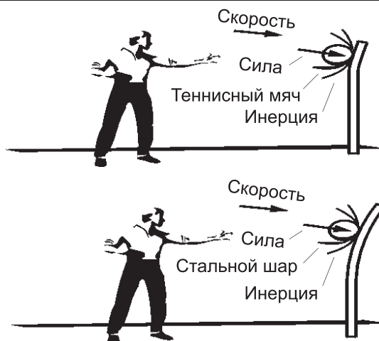
Рис. 2-4 Теннисный мяч имеет меньше инерции, чем стальной шар того же размера, если его бросить с такой же скоростью.
