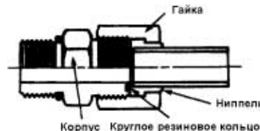
Рис. 12-4 Торцовое соединение с круглым резиновым кольцом
