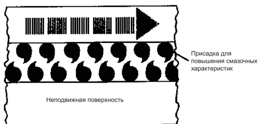
Рис. 10-23: Антифрикционная присадка может предотвратить разрыв смазочной плёнки.
