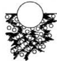
Рис. 10-34: При введении антипенной присадки образуются крупные воздушные пузырьки.
