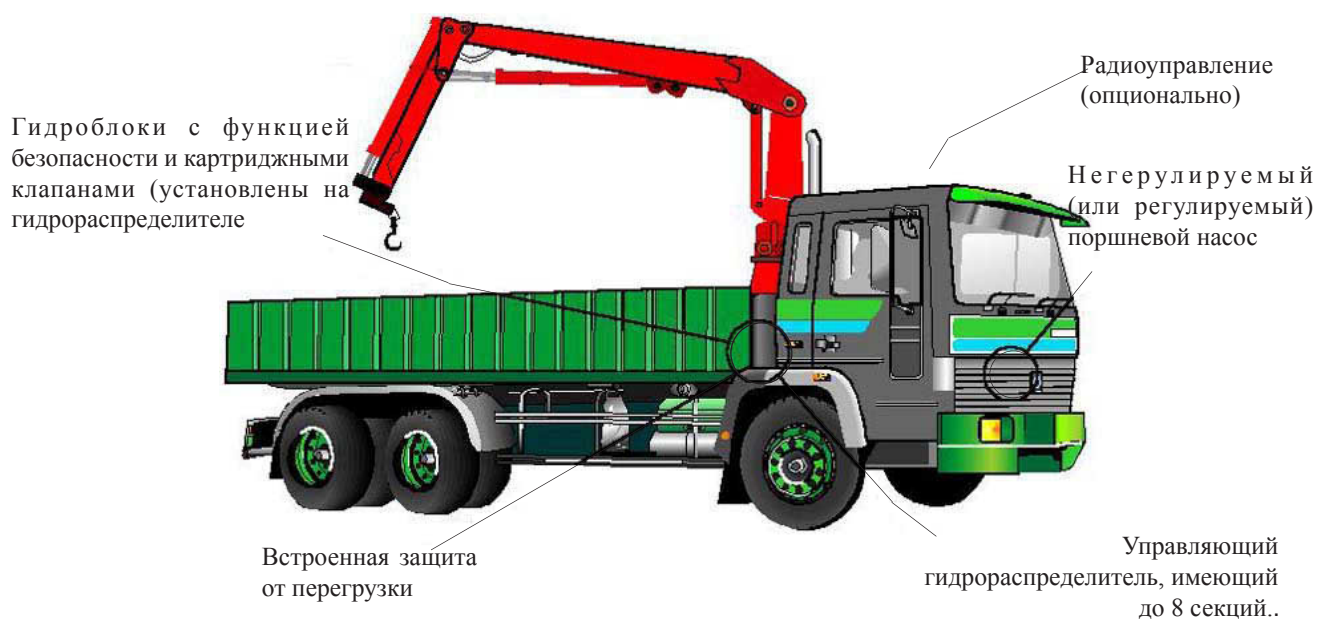
Рис. Кран-2 Грузовой кран с некоторыми компонентами управления
