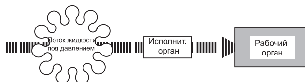
Рис. 10-2: Передача энергии в гидросистеме
