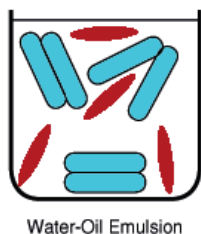
Рис. 10-50: В эмульгаторе масло разбивается на мельчайшие капли, которые переносит поток воды.
