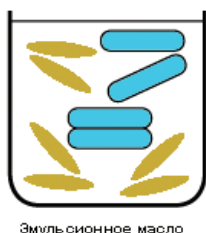
Рис. 10-52: Инвертная эмульсия 60/40 содержит 60% масла и 40% воды
