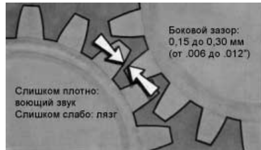
Рисунок 15-15 Правильное зацепление зубчатого колеса достигается, когда зазор между зубьями составляет от 0,15 до 0,30 мм (от .006 до .012")
