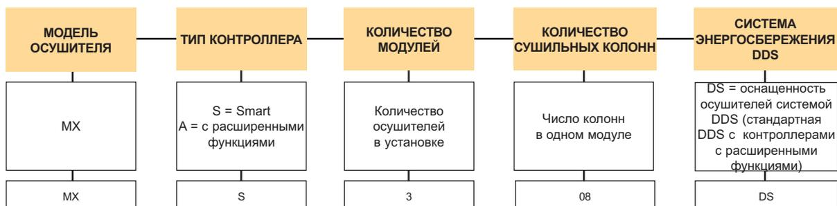
Пример обозначения: Осушитель PNEUDRI модель MXS308DS
