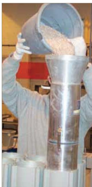
**Заполнение колонн адсорбентом по технологии Snow Storm обеспечивает постоянную точку росы**
