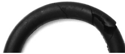
Рис. 10.10 Перекрученное уплотнительное кольцо с порезами на поверхности
