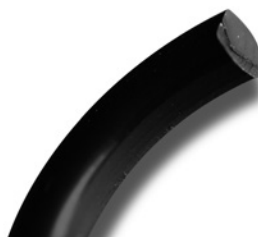
Рис. 10.12 Износ проявляется как расплющивание уплотнительного кольца с одной стороны
