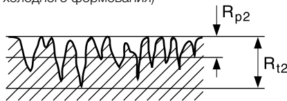
Поверхности, получаемые в результате обычной механической обработки Рис. 8.17
