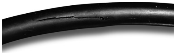
Рис. 10.11 Уплотнительное кольцо, поврежденное взрывной декомпрессией
