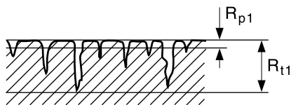
Поверхности, получаемые в результате обкатывания роликом (поверхность холодного формования)
