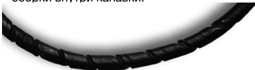
Рис. 10.9 Перекрученное уплотнительное кольцо со спиральными отметками
