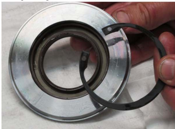
7. Вставить уплотнение вала в держатель уплотнения и установить стопорное кольцо.
