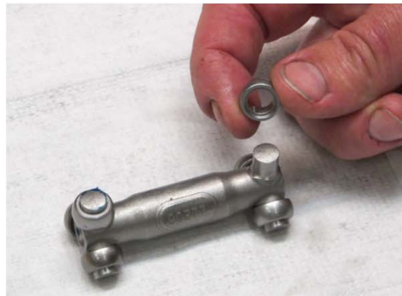
11. Установить ролики шарнира на вал шарнира. Убедиться в том, что порог на роликах шарнира направлен внутрь.
