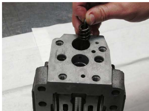
30. Установить пороговую пружину.
