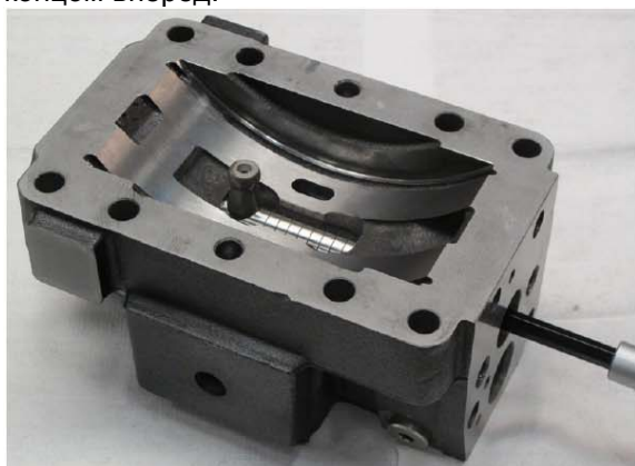
26. Закрутить регулировочный винт с моментом затяжки 26 \pm 6 Нм. Подвигать соединительный штифт назад и вперед, чтобы убедиться в том, что он перемещается плавно.
