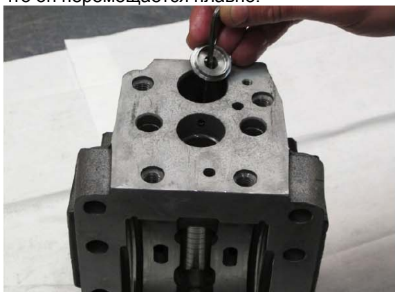
27. Установить направляющую пружины. Для установки использовать длинный торцевой ключ.
