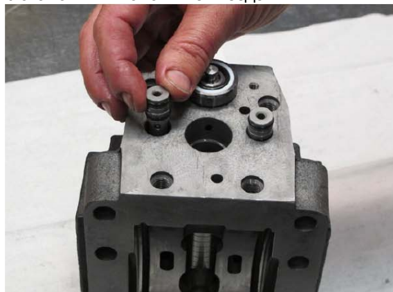
35. Установить направляющие втулки клапанов. Осторожно вбить их молотком.
