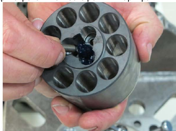
47. Установить опорный штифт. Нанести большое количество смазки, чтобы зафиксировать его на месте.
