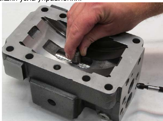
23. Установить регулировочный винт заостренным концом вперед. Убедиться в том, что он достиг фиксирующего отверстия в соединительном штифте.
