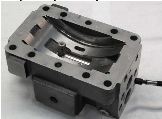
25. Установить регулировочный винт плоским концом вперед.
