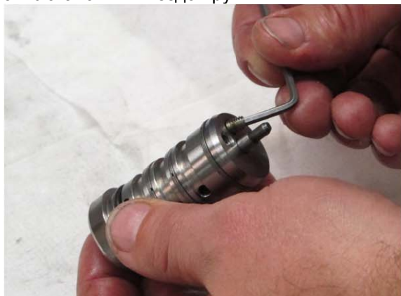
32. Установить сопла и закрутить их с моментом затяжки 1,2 \pm 0,2 Нм.
