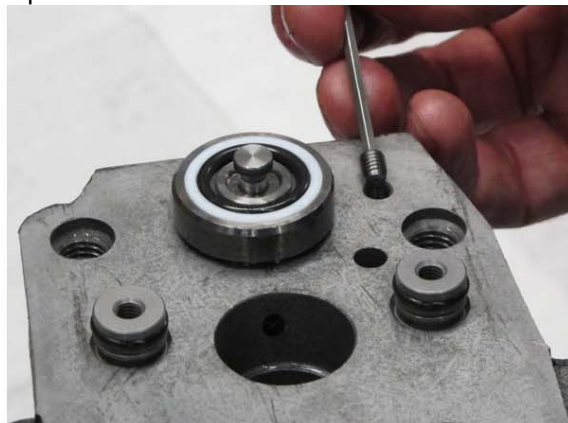
36. Установить сопла и закрутить их с моментом затяжки 1,2 \pm 0,2 Нм.
