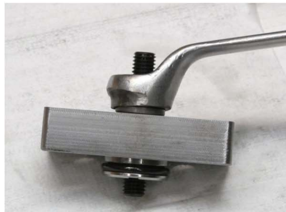
12. Установить винт регулировки смещения, уплотнительную гайку и уплотнительное кольцо.
