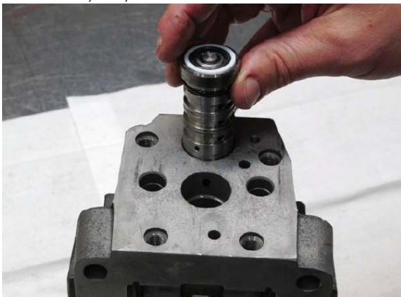
33. Установить узел гильзы клапана. Убедиться в том, что золотник достигает направляющего отверстия в гнезде пружины.
