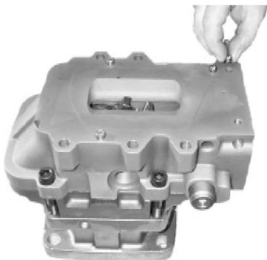
Извлечь оба шарика обратного клапана.
