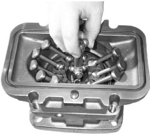
Вставить соединительный вал. Нанести на него немного смазки, чтобы ролики не выпали. Установить ролики так, чтобы их фаски были направлены внутрь.
