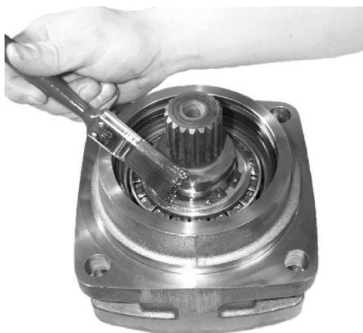
Смазать уплотнительную поверхность вала маслом.
