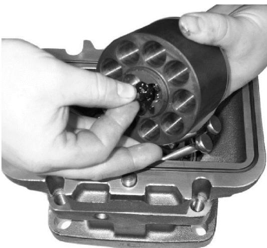
Вставить в гильзу цилиндра верхний опорный штифт. Нанести на штифт немного смазки так, чтобы он не упал при установке гильзы цилиндра.
