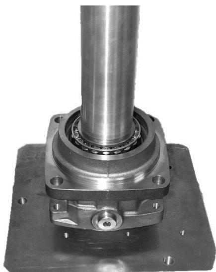
Установить на вал подшипник и вдавить его.
