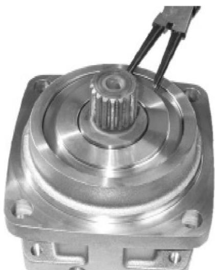
Достать держатель уплотнения с уплотнением вала. Снять и заменить уплотнение вала. Для того, чтобы вдавить его в держатель, рекомендуется использовать старое уплотнение.
