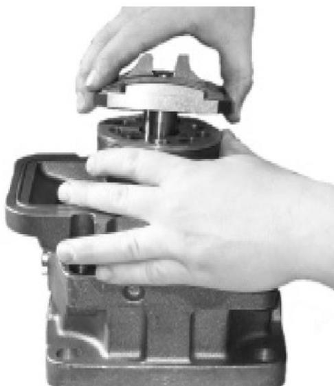
Снять секцию клапанов.
