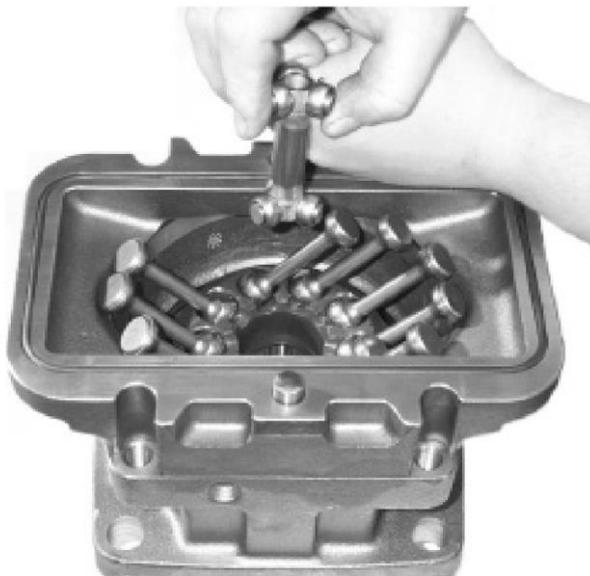
Извлечь соединительный вал. При этом нужно убедиться, чтобы так же были извлечены все соединительные ролики.
