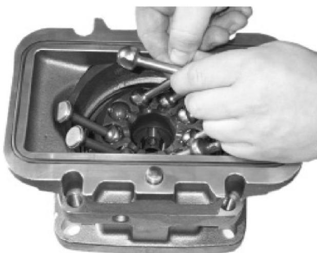
Извлечь поршни и уплотнительное кольцо, установленные в промежуточном корпусе.
